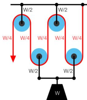
[Блок – это колесо с желобом, идущим по окружности. Человек, тянущий с одного конца веревку, может поднять вес на другом конце веревки. Колесо блока выполняет роль точки опоры, уменьшая силу, необходимую для подъема груза. – *Ред.*]
